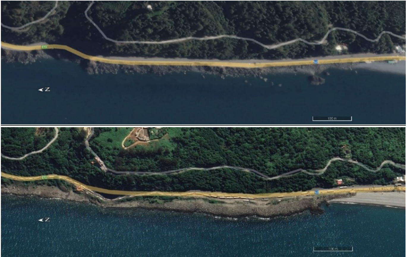
სურათი 27. მდგომარეობა 2013 ნაპირდაცვითი სამუშაოების ჩატარებამდე (ზემოთ) და 2023 წლებში ნაპირდაცვითი სამუშაოების ჩატარების შემდეგ (ქვემოთ)
